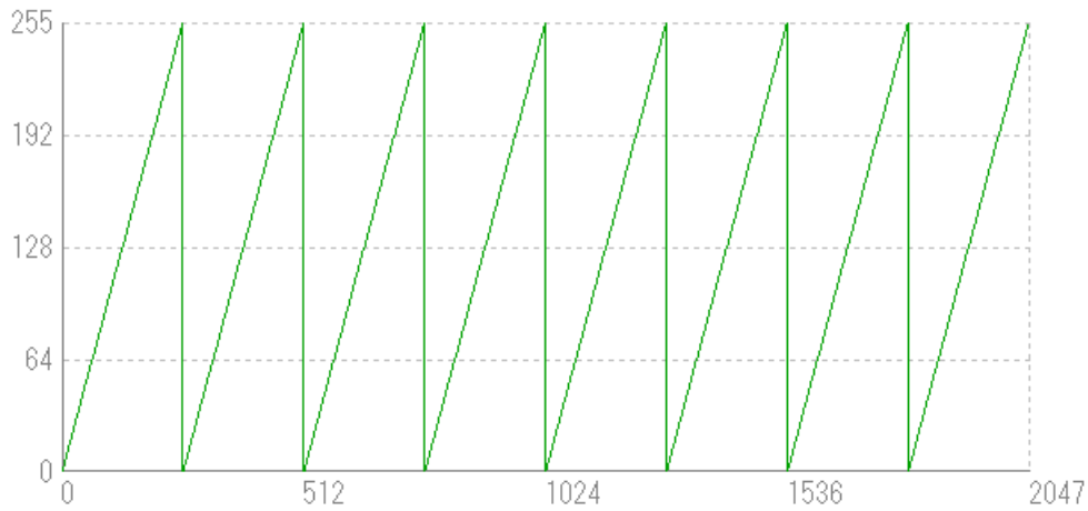
図 4-10-8-1 Mono8 の水平ランプパターンライン波形
