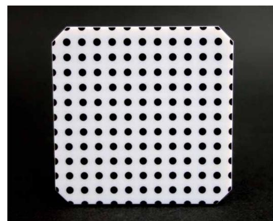
ガラス、PETなどの基材を用いて多様な反射型チャートをご提供しています。
