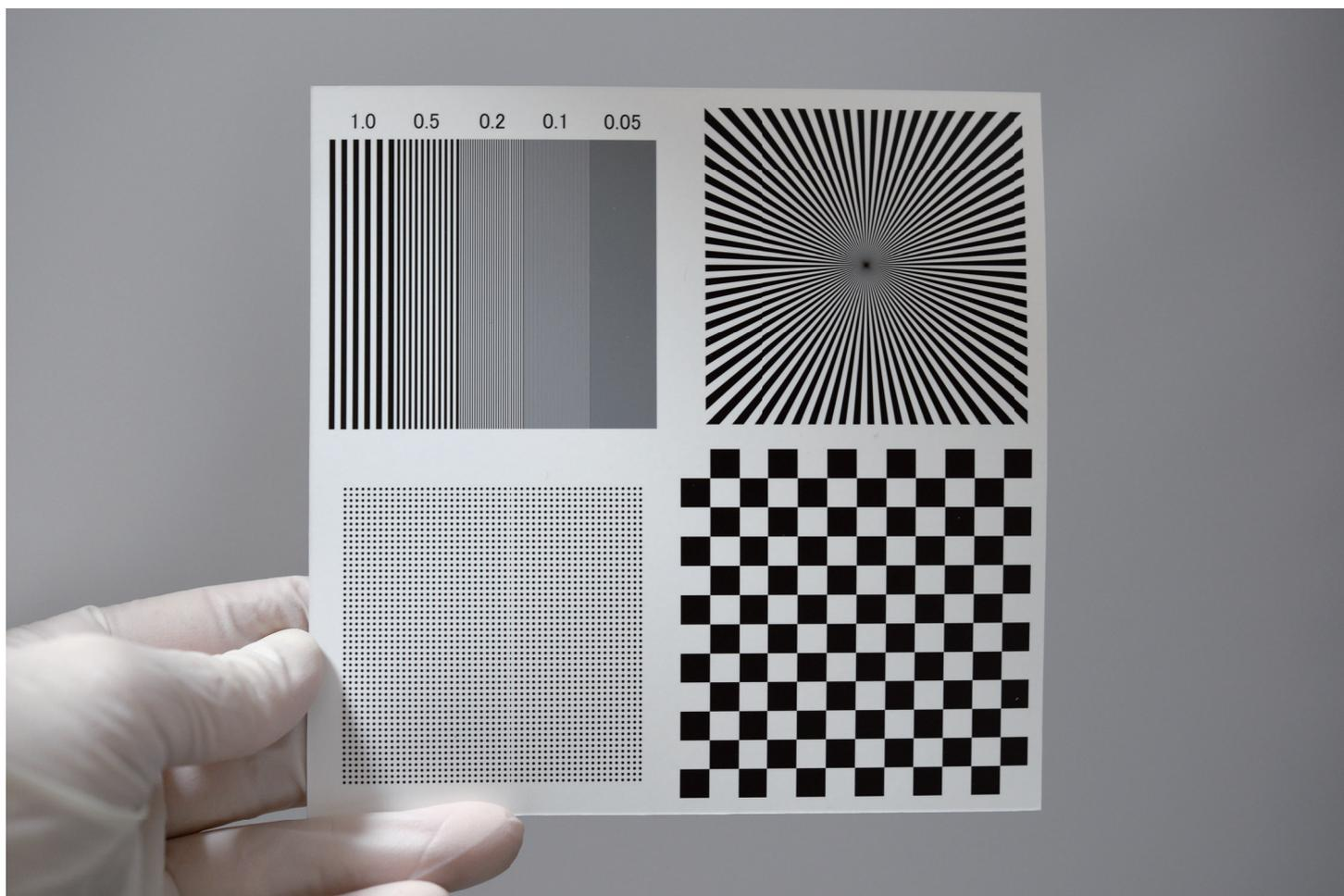
印画紙チャートは写真感光材料である白黒の印画紙を用いて製作された反射型テストチャートです。各種スキャナのキャリブレーション、カメラ撮影の解像チャート、ディストーションチャート等として用いられております。密着性を高めた露光プロセスを用いることにより、シャープなパターンエッジを表現しています。
