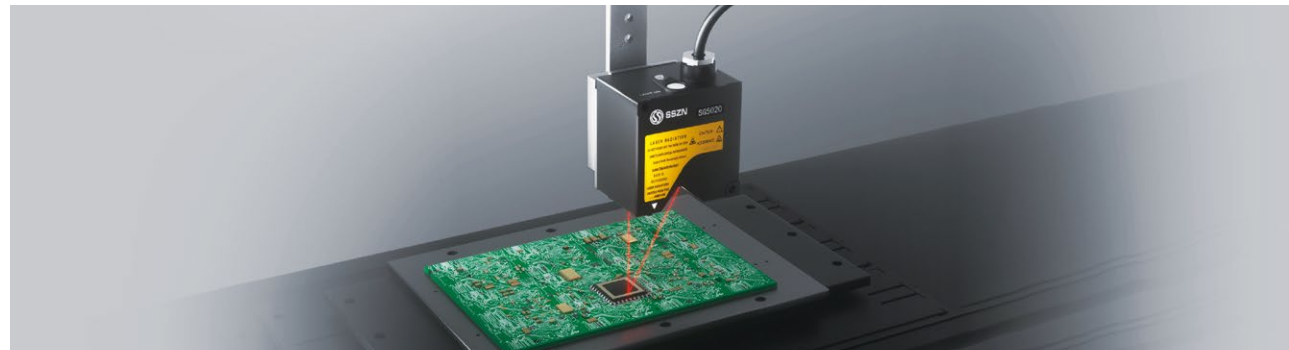
PCBの高さと変形の検出
