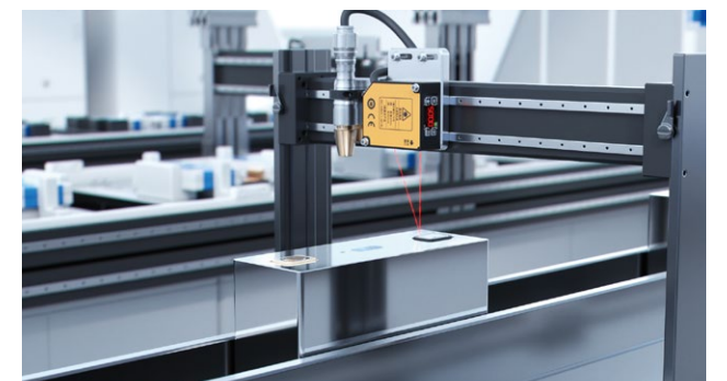
トップカバー溶接の焦点ドリフト検出
