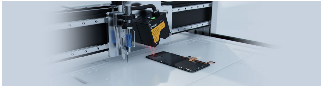
携帯電話の画面の盲穴ディスペンシングガイド
