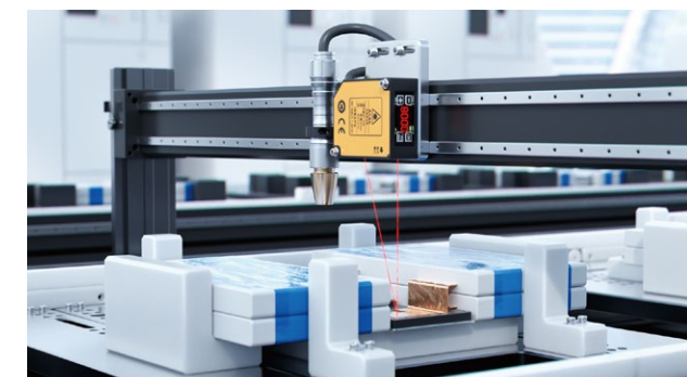
タブ溶接の焦点ずれ検出
