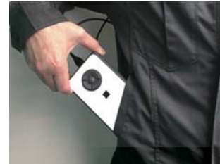
データ収録時は、 ポケットに入る バッテリーバック 付端末 (310g) だけ携帯します。
