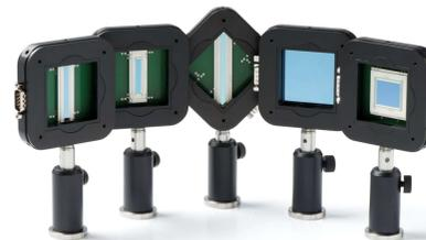
PSDをホルダーに搭載したモデルのMH01 (1軸2.5mm-20mm、2軸2×2-20×20mm2用)、MH02 (1軸30mm-60mm、2軸20mm×20mm-45mm×45mm2用) シリーズはメカニカルホルダーD-SUB9Pinコネクタ付  $\phi$ 1インチ光学用マウント/ロッド(M4)が装着できるように設計されています。
