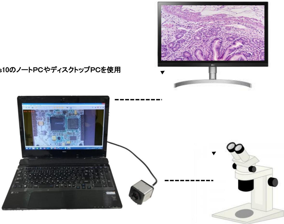
Cマウントカメラなのでアダプタにて顕微鏡に簡単に取り付け出来ます。
