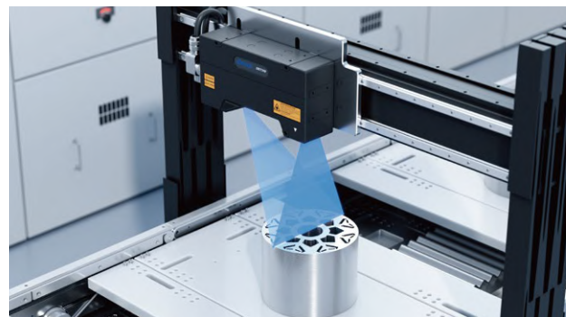
フラットワイヤーモーターローター磁石の欠陥検出
