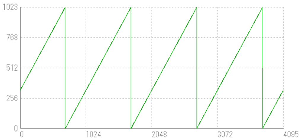
図 4-10-8-7 Mono10 の水平垂直ランプテストパターンライン波形
