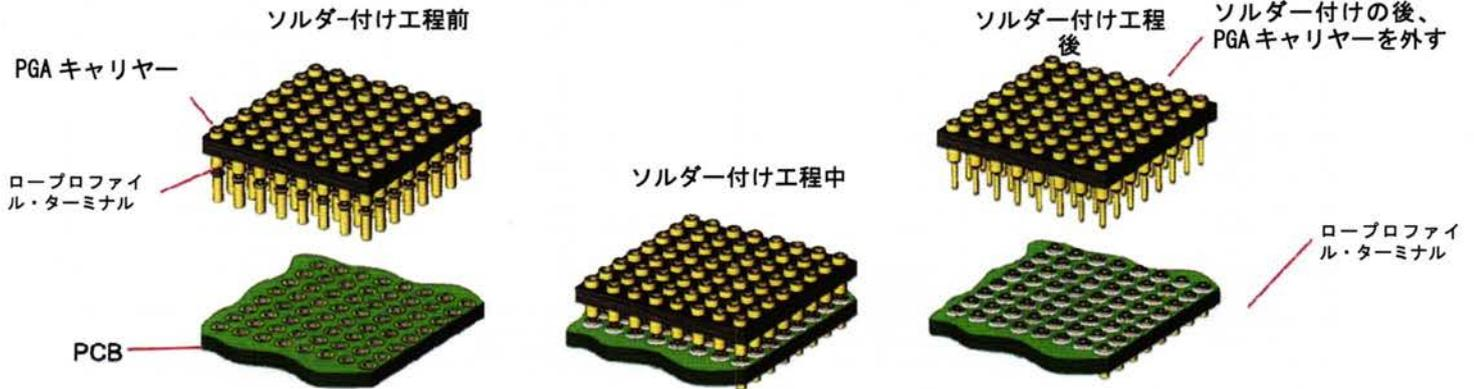
PGA キャリヤーアセンブリが御社におけるソルダー付け工程でもロー・プロファイル・ターミナルの状態を保つのでソルダー付け後に省スペースで位置種直性共に正確なサブストレートの無いソケットが出来上がります。工程後は PGA キャリヤーは廃棄されても、再使用の為クロニクスまでご返送頂いても結構です。
