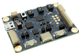
USB-M Flexiboardを拡張したボードで、A-PE-シリーズのレンズを制御できるように専用のコネクタが搭載されています。A-PE-シリーズの開発キットに付属します。
