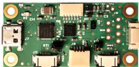
A-シリーズ、C-S-シリーズ、C-u-シリーズ用にMaximドライバーICと4ピンのFPCコネクタを搭載したドライバーボードです。開発キットで提供されるFocusLabソフトウェアを使用してUSB経由で簡単に駆動することが可能です。非常に小さな形状をしており特別にハードウェアを開発することなくこのボードを直接PC駆動のアプリケーションに使用することが可能です。
