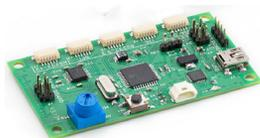
USBからRS232-12V/RS232-3.3V/I2C/SPIに変換するボードです。USBケーブルでPCと接続して、C-Cモジュールをボードに接続します。FocusLabを使用して全てのC-Cバージョンと直接通信することが可能です。ポテンショメータでコンピュータを介さずにC-Cの電圧を直接制御することも可能です。
