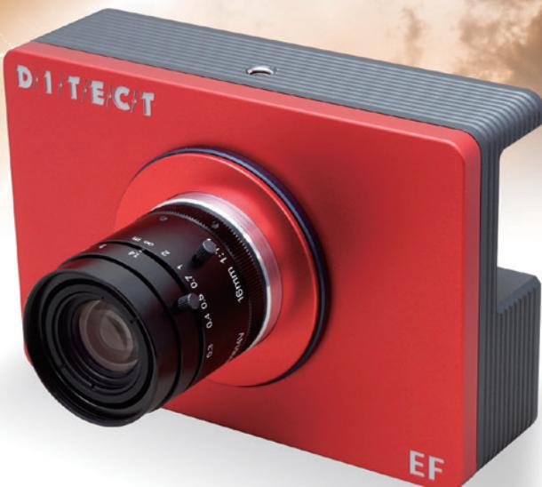
HAS-EF は、有効画素数 520 万画素 2,560×2,048 ドット 1インチの CMOS センサーにより、フルフレームで 250 コマ / 秒 フルハイビジョンで 500 コマ / 秒、VGA で 1,400 コマ / 秒 最大 14,000 コマ / 秒の高速度撮影が可能なハイスピードカメラです 内蔵メモリを 6GB 有し、フルスペックでの複数台同期撮影も可能です
