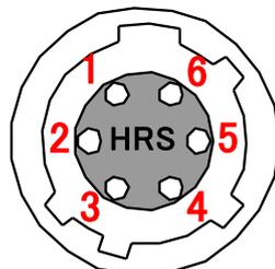
図 3-3-1 カメラ側電源コネクタ（ヒロセ：HR10G-7R-6PB）
