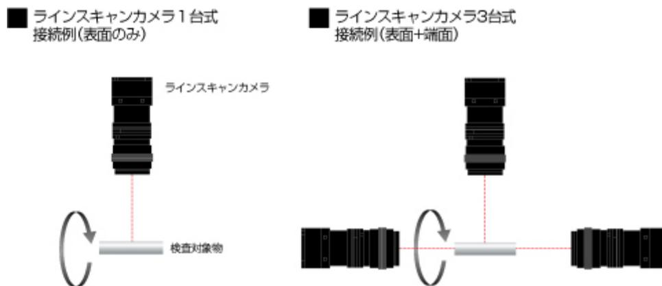
図 1-2-1 円筒状表面外観検査カメラ構成
