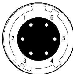
図 3-3-4 カメラ側電源コネクタ（ヒロセ：HR10G-7R-6PB）
