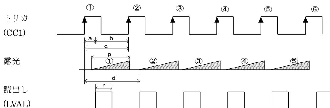
図 4-8-2-1 外部トリガ（トリガエッジ）露光モード
