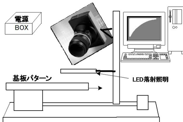
図 1-2-1 プリント基板の外観検査装置
