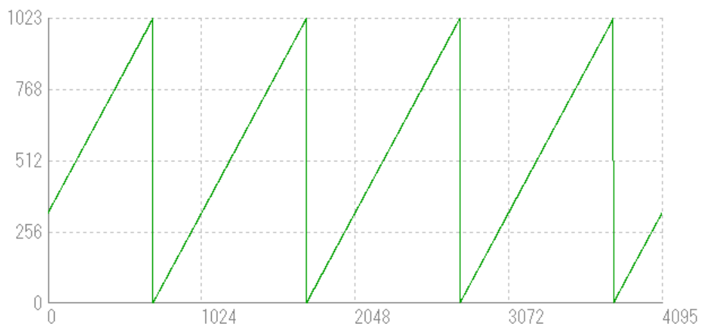
図 4-10-4-7 Mono10 の水平垂直ランプテストパターンライン波形
