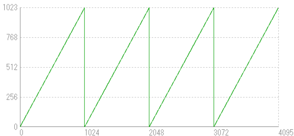
図 4-10-4-3 Mono10 の水平ランプパターンライン波形
